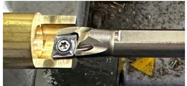
Nóż typu "Dimple Bar" Minimalna średnica skrawania 10 mm
